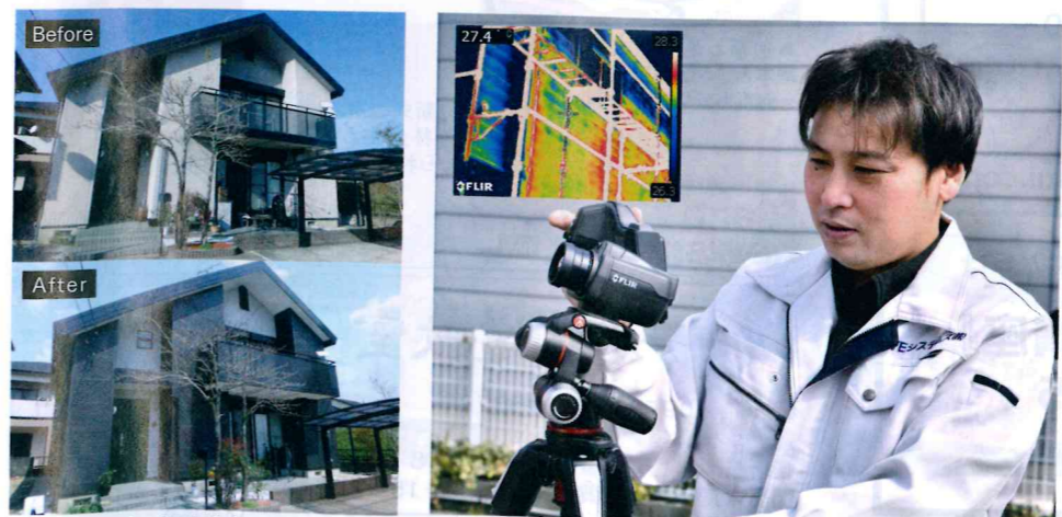
▲塗装前(左)と塗装後(右)の写真。家の雰囲気もガラリと変わります。 ▲様々な診断に用いる『赤外線サーモグラフィー』。例えば、壁の間にある空気の層を見つけ出すことができ、雨漏り診断の際にも的確に場所を把握することができます。
